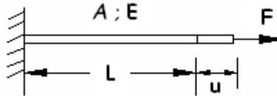
**Fig.5.2 Deformación de un elemento axial sometido a carga axial**
